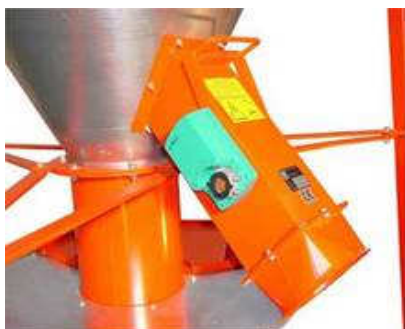
опционално: електрически изход на смесителя - патент "Грубер"
